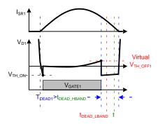
Figure 46. When  $T_{DEAD} > t_{DEAD\_HBAND}$
