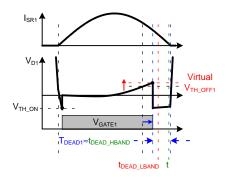
Figure 47. When T<sub>DEAD</sub> = t<sub>DEAD\_HBAND</sub>
