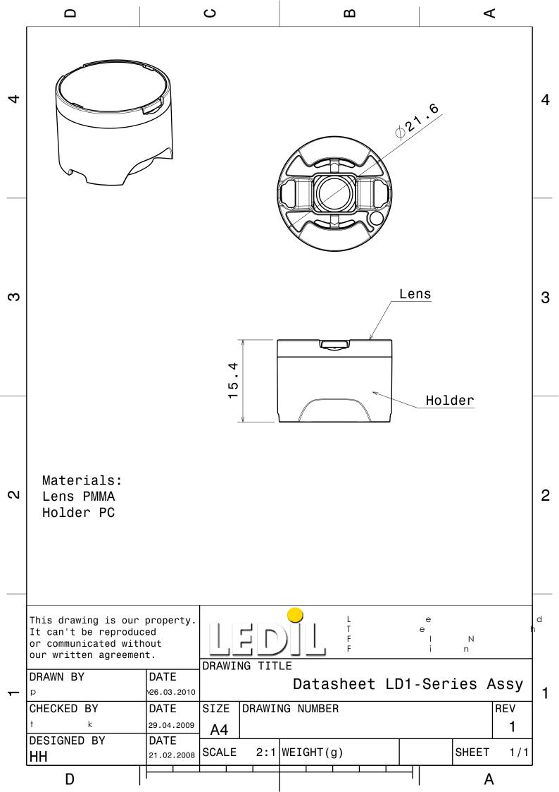
Luminaire: Ledil Oy FA10796\_LD1-RS FA10796\_LD1-RS Lamps: 1  $\times$  Osram Diamond Dragon
