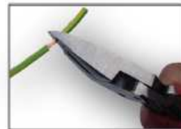
Abisolieren Stripping 1,5 + 2,5 mm 2
