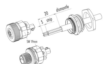
*Wire cross section* max. 1,5 mm<sup>2</sup> 4, 5 *contacts*
