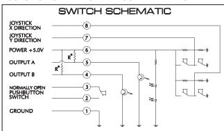
\*EXTERNAL PULL-UP RESISTORS REQUIRED FOR OPERATION (2.2k $\Omega$ ).
