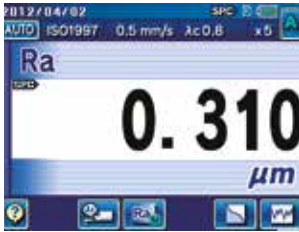
1-parameter display: one parameter measurement result
